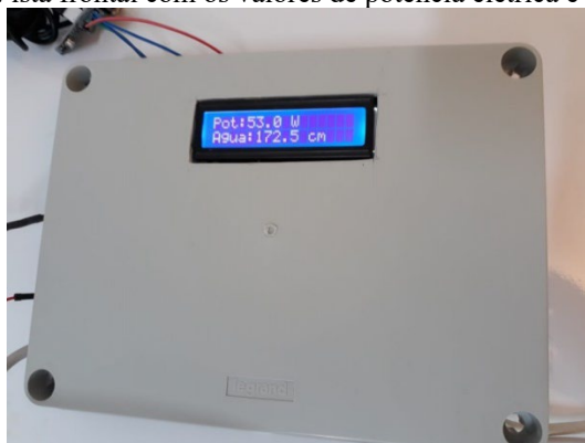
Figura 06: Vista frontal com os valores de potência elétrica e nível da água.
