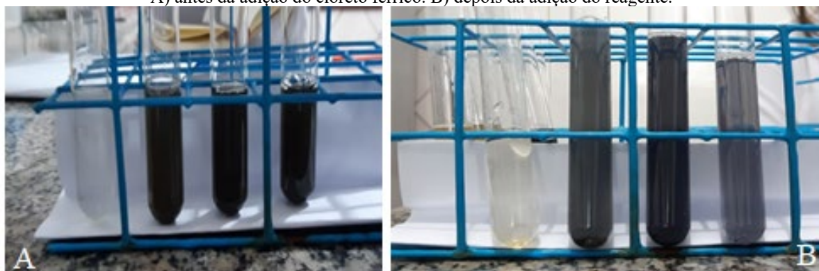
Figura 1: Resultado para o teste de fenóis nos extratos bruto A, B e C, respectivamente. A) antes da adição do cloreto férrico. B) depois da adição do reagente.
