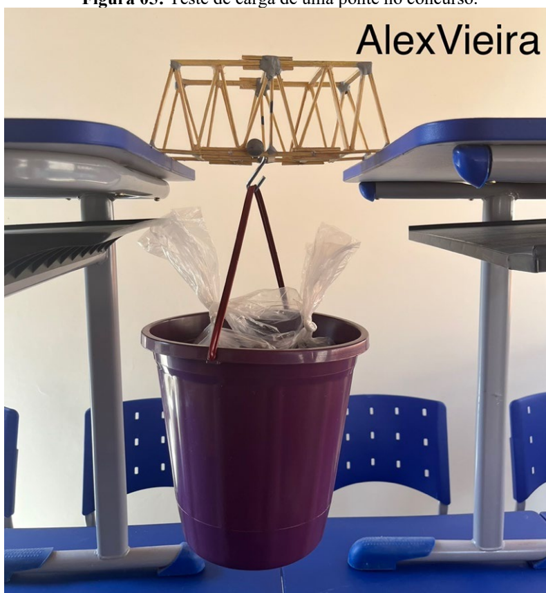
Figura 05: Teste de carga de uma ponte no concurso.
