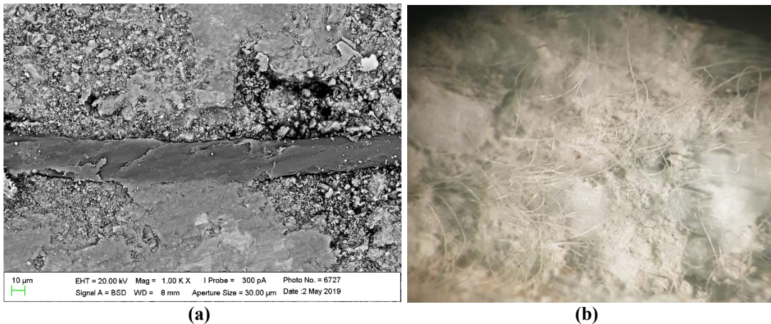
Figura 15 – Imagens MEV: (a) interação da fibra de polipropileno com a matriz cimentícia (b) aleatoriedade das fibras no concreto.
