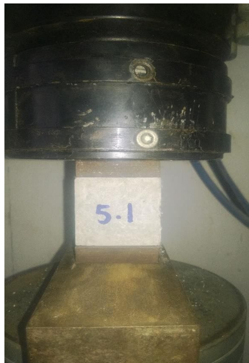
Figura 12 - Aparelho do ensaio de Resistência à Compressão.
