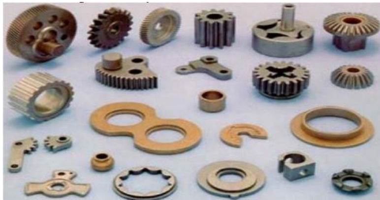
Figura 18 - Exemplos de peças obtidas a partir de metalurgia do pó.
